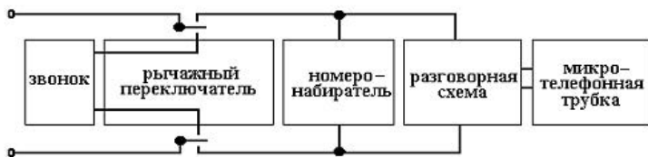
Рисунок 9.3.3 — Структурная схема телефонного аппарата
