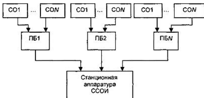
Рисунок 3.1.2 — Радиальное (лучевое) с концентраторами соединение станционной аппаратуры с ПБ и СО
