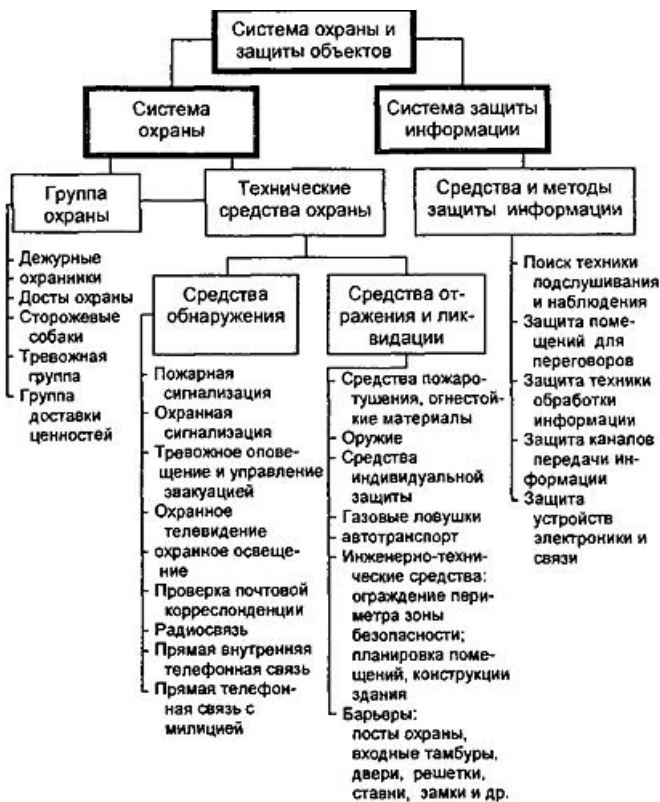
Рисунок 3.5.1 — Обобщенная схема системы охраны и защиты объекта
