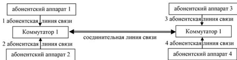
Рисунок 9.3.1 — Состав телефонного канала связи
