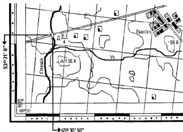
Рисунок 6.2.1 — Определение географических координат
