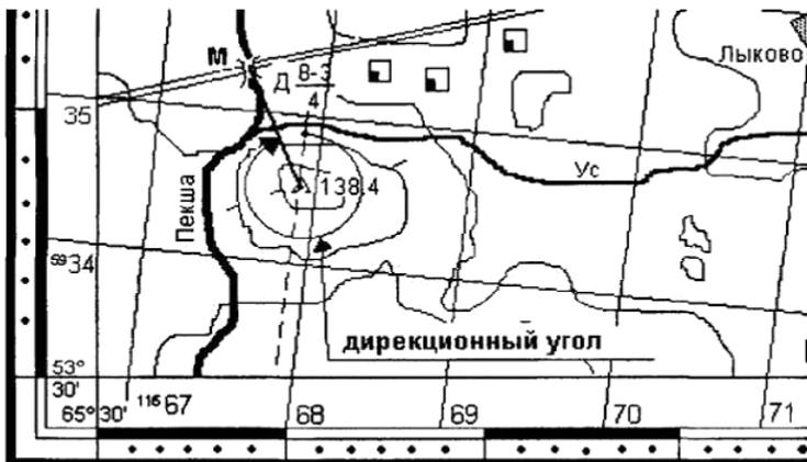
Рисунок 4.1.1 — Дирекционный угол с точки стояния отметка 138,4 на точку М (мост) = 330°
